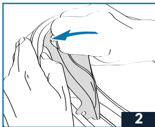
2 - Glisser le revers plastique central de la bavette entre la calotte et l'EPS.
