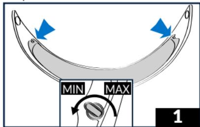
1 - Coloque la pantalla en una mesa de trabajo y sobre una superficie suave. Asegúrese de que la superficie interna de la pantalla esté limpia. Con la ayuda de una moneda, controle que los pivotes para ajuste externos estén correctamente dispuestos hacia adentro (posición «INT»).
