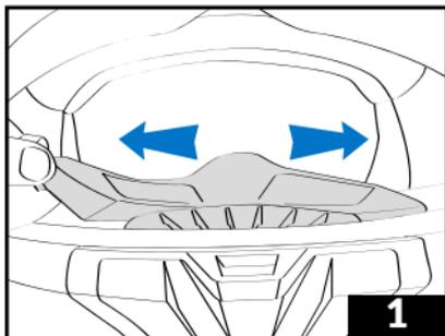
1 - Ejercer una traslación lateral para su montaje o desmontaje.
