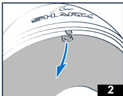
2 - Extraer la espiga de fijación central con un destornillador o cualquier otra punta.
