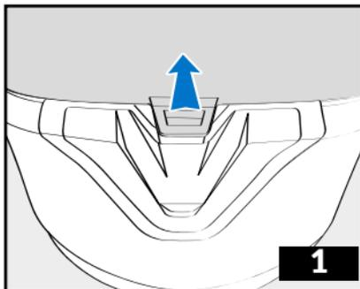
1 - Öffnen Sie das Visier einen Spalt; Klappen Sie das Visier mit dem mittleren Visiergriff hoch.
