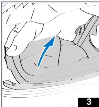
3 - Déclipser la partie avant de la coiffe, clip par clip, en tirant vers l'intérieur et en partant d'une extrémité au choix.
