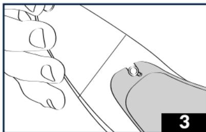
3 - Insérer un côté du film PINLOCK® dans l'un des deux pins aux extrémités de l'écran et le garder en position.
