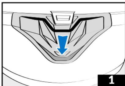
1 - Per aprire la ventilazione inferiore, collocare il cursore in posizione bassa.
