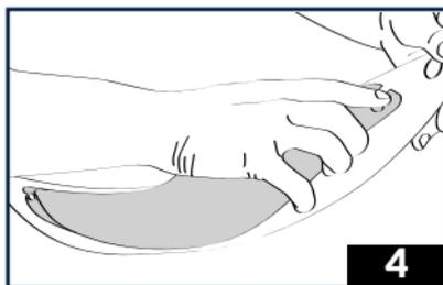
4 - Dehnen und biegen Sie das Visier und stecken Sie die zweite Seite der PINLOCK®-Folie in den zweiten Pin. Lassen Sie das Visier los, damit es seine gebogene Form wiedererlangt.
