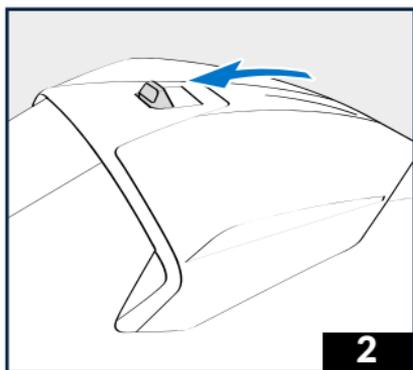
1 & 2 - Stellen Sie den Knopf zur Nutzung der oberen Belüftung nach hinten (geöffnet) (1); nach vorne (geschlossen) (2).
