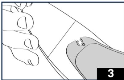
3 - Inserte un lado de la lámina PINLOCK® en uno de los dos pines en los extremos de la pantalla y cuide que no se salga.
