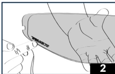
2 - Placer le film PINLOCK® sur l'écran. Le joint en silicone du film PINLOCK® doit être en contact avec la surface intérieure de l'écran. Logo PINLOCK® lisible côté face externe de l'écran.
