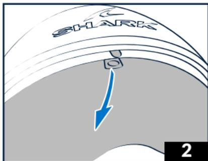
2 - Nehmen Sie den mittigen Befestigungsstift mithilfe eines Schraubenziehers oder eines anderen spitzen Gegenstands heraus.
