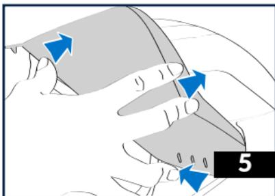
5 - Presser les boutons «L» & «R» en simultanée, puis pousser à l'aide de vos autres doigts de part et d'autres sous l'écran pour le dégager vers l'arrière du casque. Retenir l'écran en fin de mouvement.
