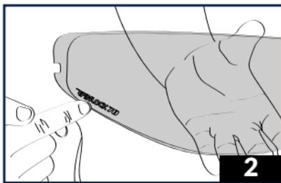
2 - Coloque la lámina PINLOCK® sobre la pantalla. El sello de silicona de la lámina PINLOCK® debe estar en contacto con la superficie interior de la pantalla. Logo PINLOCK® legible del lado de la cara externa de la pantalla.
