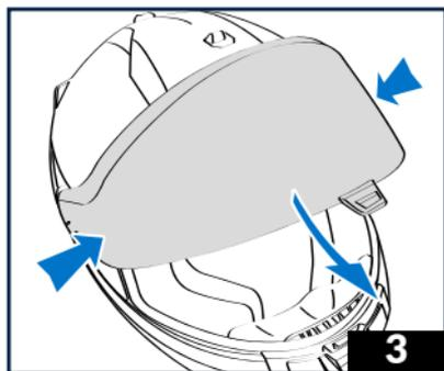
3 - Presionando a cada lado de la pantalla y haciendo un movimiento circular de la pantalla hacia abajo, la pantalla se traba naturalmente.
