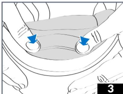
5 - Bringen Sie die zwei Befestigungsclips der Abdeckung wieder an einer Seite und dann an der anderen Seite an der dafür vorgesehenen Stelle an. Drücken Sie dann darauf, um sie zu befestigen.
