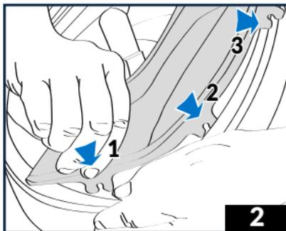
2 - Klippen Sie die drei Befestigungsclips pro Wangenpolster in ihr Gehäuse. Beginnen Sie mit dem hinteren Clip, dann der mittlere und der vordere.
