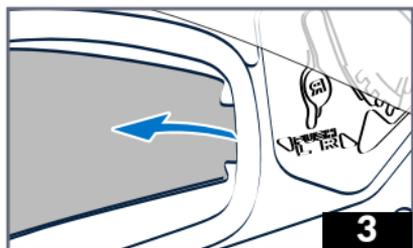
3 - Desenganchar lateralmente el visor solar de ambos lados tirando hacia usted y manteniéndose en eje.
