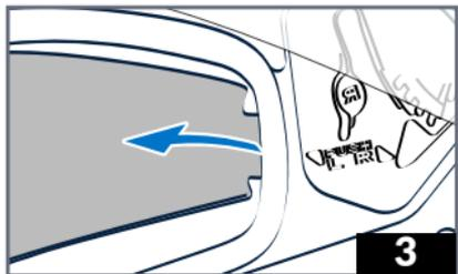
3 - Nehmen Sie die Sonnenblende seitlich von einer Seite ab und dann von der anderen Seite ab, indem Sie sie zu sich ziehen und in derselben Ausrichtung bleiben.
