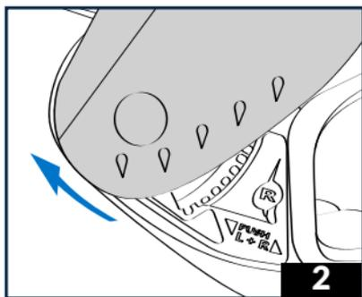
2 - Legen Sie das Visier in erhöhter Position an die Seitenplatten und stützen Sie es auf beiden Seiten davon auf die Visierstufe.
