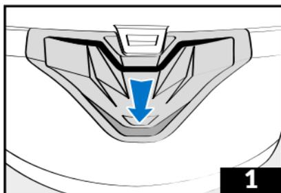
1 - Stellen Sie den Cursor zum Öffnen der unteren Belüftung in die untere Position.
