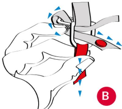
**⚠ ACHTUNG!** Verwenden Sie niemals die Schlaufe als einzigen Verschluss des Kinnriemens. Damit der Kinnriemen richtig zugezogen ist, muss er gemäß den Anweisungen durch die Doppel-D-Ringe geführt werden. Jegliche falsche Verwendung des Kinnriemens kann dazu führen, dass Ihr Helm bei einem Unfall abgeworfen wird und der Kopf schutzlos ist. Versuchen Sie, mit den Fingern am Kinnriemen zu ziehen. Wenn sich die Schlaufe irgendwie lockert, haben Sie den Kinnriemen nicht korrekt in den Doppel-
