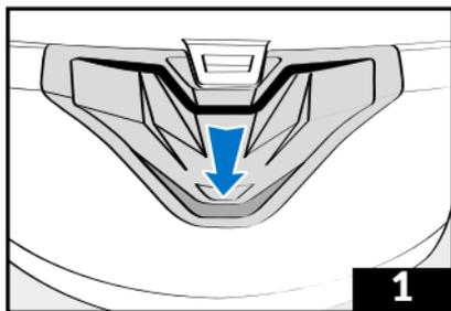
1 - Para abrir la ventilación inferior, colocar el cursor en posición baja.
