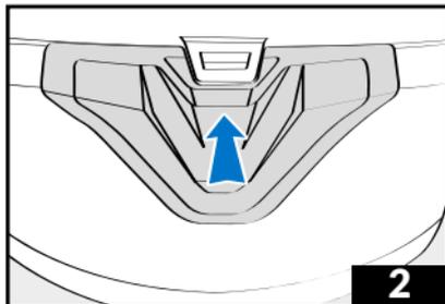
2 - Stellen Sie den Cursor zum Wiederverschließen der Belüftung in die obere Position.
