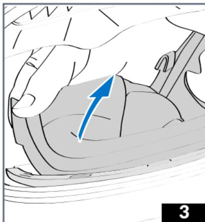
7 - Desenganchar la parte delantera del forro, quitando los clips uno por uno, tirando hacia el interior y partiendo del extremo que prefiera.
