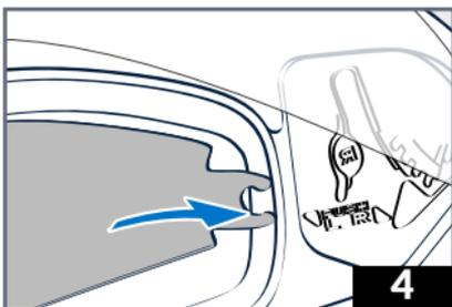
4 - Volver a enganchar el visor solar de un lado y otro.
