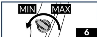
6 - Drehen Sie die 2 Hebel nach Außen, um die Spannung der Folie zu verstärken (Drehung in Richtung „MAX“).
