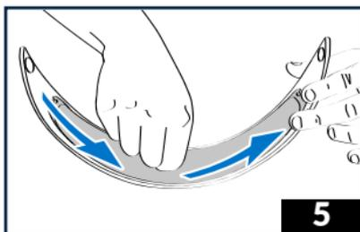
5 - Achten Sie darauf, dass die ganze Silikondichtung der Folie am Visier haftet. Ansonsten passen Sie die Spannung der Folie mithilfe der äußeren Einstellhebel und einem Geldstück an.
