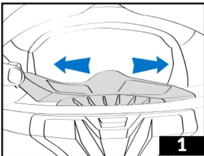
1 - Effettuare uno spostamento laterale per il suo montaggio o smontaggio.
