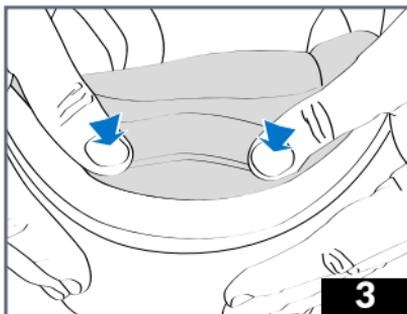
5 - Repositionner d'un côté puis de l'autre chacun des deux clips de fixation de la coiffe face à leur logement puis presser-les pour les fixer.
