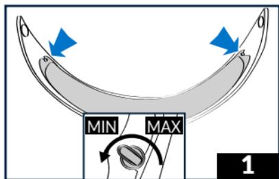
1 - Legen Sie das Visier auf eine Arbeitsfläche und eine weiche Unterlage. Vergewissern Sie sich, dass die innere Oberfläche des Visiers sauber ist. Überprüfen Sie mithilfe eines Geldstückes, ob die äußeren Einstellhebel nach innen gerichtet sind (Position auf „INT“).
