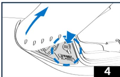
4 - Auf jeder der seitlichen mechanischen Platten befindet sich auf beiden Seiten des Visiers ein Druckknopf mit der Aufschrift „R“ auf der rechten Seite und der Aufschrift „L“ auf der linken Seite.
