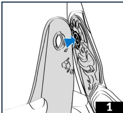
1 - Machen Sie das System mit den Einkerbungen des Visiers auf jeder der Seitenplatten der Visiermechanik ausfindig.
