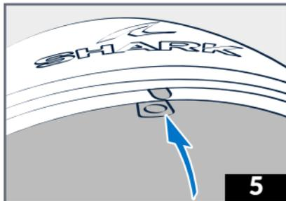
5 - Drücken Sie mithilfe eines Schraubenziehers oder eines anderen spitzen Gegenstands durch das Innere auf den mittigen Befestigungsstift. Bringen Sie die Sonnenblende dann wieder an, indem Sie sie leicht anheben.
