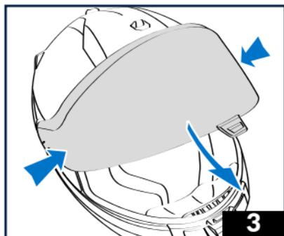
3 - Au moyen d'une pression sur chaque côté de l'écran et d'un mouvement circulaire de l'écran vers le bas, le verrouillage s'opère naturellement.
