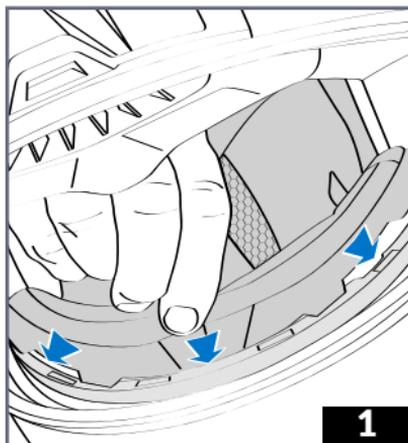
1 - Deslice el forro en el interior del casco. Tenga cuidado de reinsertarlo del lado correcto. Vuelva a colocar la parte delantera del forro. Enganche los cinco clips en sus respectivos espacios. Empiece por el clip central que debe deslizarse por encima de la flecha que figura en el soporte del forro, luego, vaya enganchando uno tras otro los cuatro clips laterales.
