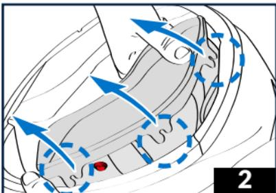
2 - Dar vuelta el casco y desprender las almohadillas de cada mejilla, primero una y luego la otra. Desenganchar cada almohadilla de mejilla de sus 3 compartimentos de fijación en el siguiente orden: extremo posterior, luego central y finalmente delantero. Tirar hacia el interior del casco.
