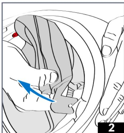
1 & 2 - Schieben Sie Ihre Hand unter die Rückseite der Abdeckung und ziehen sie sie an beiden Seiten zu sich, um die Abdeckung aus ihren beiden Clip-Befestigungsgehäusen zu befreien.
