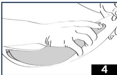
4 - Estire, incline y calce el segundo lado de la lámina PINLOCK® en el segundo pin. Suelte para que la lámina adquiera su forma curva.
