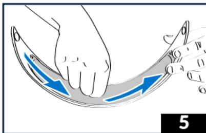
5 - Verifique todo el sello de silicona que rodea la lámina esté adherido a la pantalla. De no ser así, ajuste la tensión de la lámina con los pivotes de ajuste externo y con una moneda.
