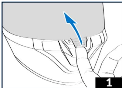
1 - Öffnen Sie das Visier einen Spalt, indem Sie unter den mittleren Visiergriff drücken.
