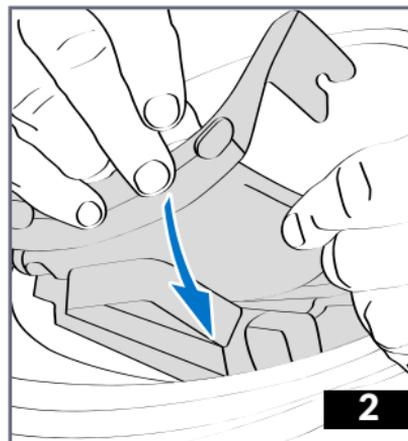
2 - Repositionner l'arrière de la coiffe
