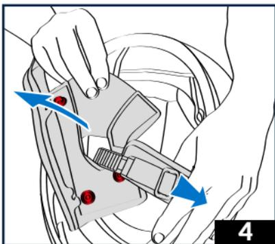
4 - Nehmen Sie jedes Wangenpolster komplett von innen ab, indem sie sie über die äußersten Enden des Kinnriemens gleiten lassen. Drehen Sie den Helm gleichzeitig um, falls nötig.
