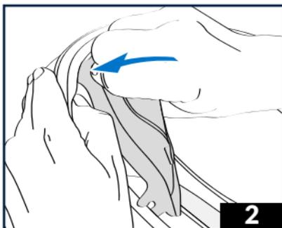
2 - Schieben Sie den mittleren Plastikrand der Maske zwischen die Kalotte und das EPS.
