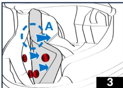
3 - Drehen Sie den Helm nochmal um, um einfacher auf jedem Wangenpolster zwei Druckknöpfe vorne, einen seitlichen Klettverschluss und einen Druckknopf hinten aufzumachen. Halten Sie die beiden Klettverschlüsse so gut wie möglich an beiden Seiten fest, um den Bereich (A) vorsichtig abzunehmen.
