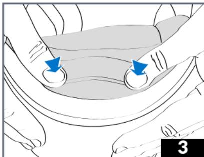
5 - Volver a repositionar, de un lado y luego del otro, los dos clips de fijación del forro y luego apretarlos para que queden fijos.
