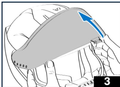
3 - Das Visier muss bis zum maximalen Öffnungsanschlag hochgeklappt werden.
