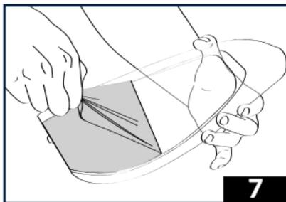
7 - Quitar la película protectora de la lámina PINLOCK® antes de volver a colocar la pantalla en el casco.
