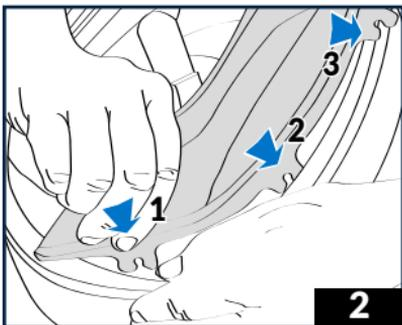
2 - Enganche los tres clips de fijación en su correspondiente espacio comenzando por el clip posterior, siguiendo por el del medio y terminando por el delantero.
