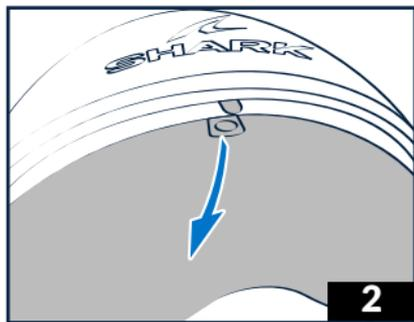
2 - Extraire le téton de fixation central à l'aide d'un tournevis ou d'une pointe quelconque.
