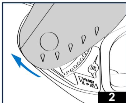
2 - Présenter l'écran en position haute au niveau des plaques latérales et en appuyer sur la marche d'écran de part et d'autre de celui-ci.
