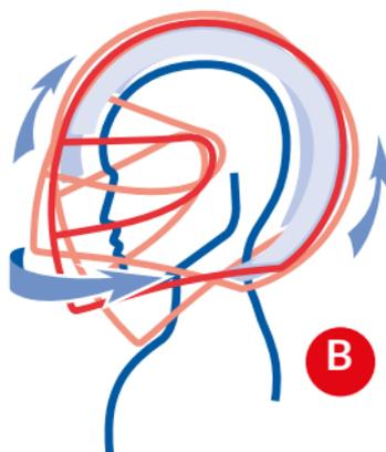
3. Con il sottogola stretto, impugnare il lato posteriore del casco dalla base e provare a ritrarlo dalla testa con un movimento di rotazione.
