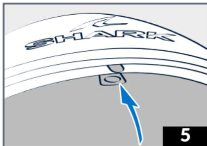
5 - A l'aide d'un tournevis ou d'une pointe quelconque, appuyer par l'intérieur sur le téton de fixation central puis reclipser le pare-soleil en le relevant légèrement.
